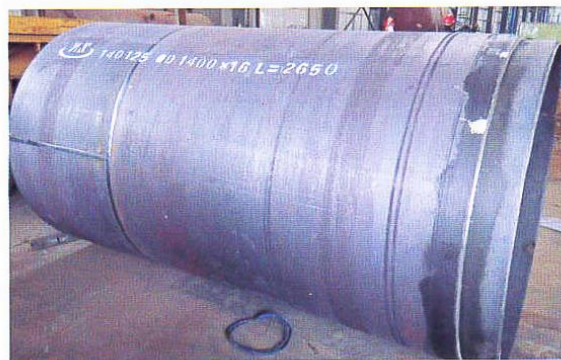
带咀钢管/Steel Sleeve Pipe 型号: OD1400mmx16mm厚(thk) x 2500mm长(L)
