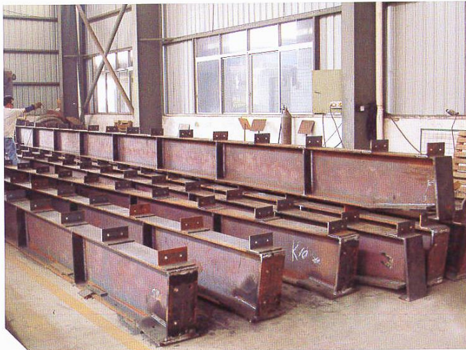
图为厂房钢结构的一部分：金字梁（左）和立柱（右）
