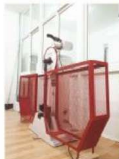
冲击试验机 Impact inspection machine
