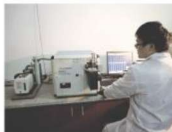
直读光谱仪 Spectrum analyzer
