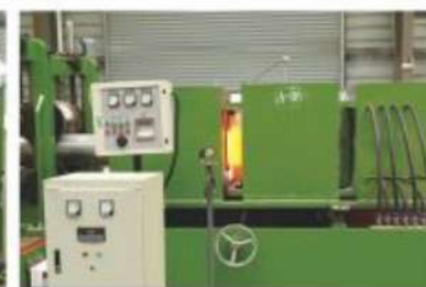
在线固溶热处理 Online solution annealing
