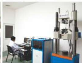
万能材料试验机 Universal tensile tester
